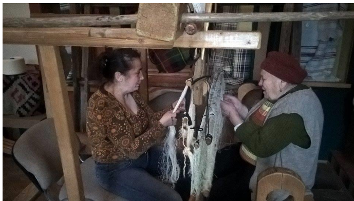
Petrecutul urzelii printre firele itelor și dinții spatei - una dintre cele mai dificile și migăloase operațiuni pentru montarea stativelor: d-na MILUCA SFÎCA și NICOLETA IRIMESCU
